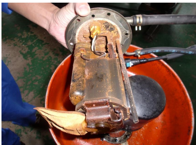
□燃料ポンプ錆状況
