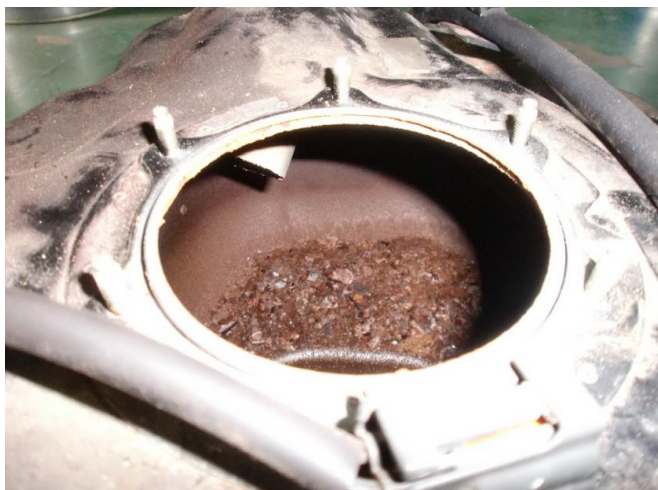
□燃料タンク内、錆蓄積状況
