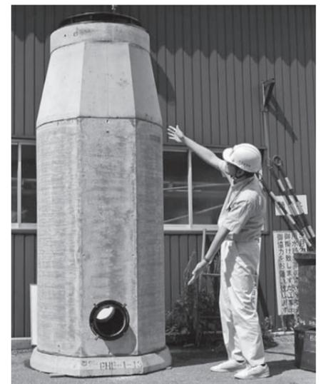
マンホールは、下水道管を維持・管理するためのもので、下水道管の曲がる場所や高さを変更する場所に設置されています。ふたは直径60cmですが、内部は直径90cmとなっています。大きさは下水道管の深さによって変わります。
