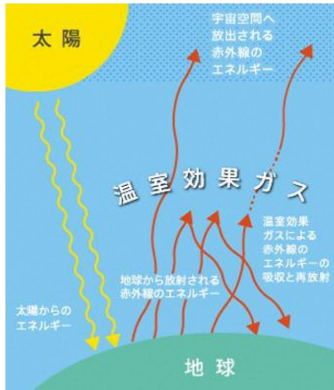
図 1.1 地球温暖化のメカニズム
